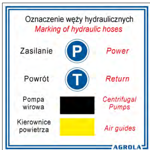
Rys. 57. Oznaczenie węży hydraulicznych – piktogram (P41)
