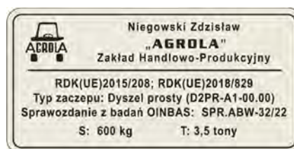
Rys. 65. Tabliczka znamionowa dyszla prostego
